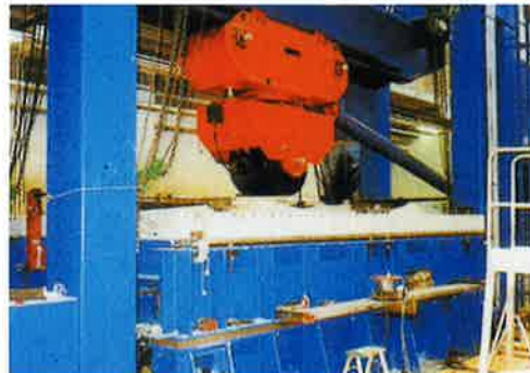
旧建設省土木研究所(財)土木研究センター、民間15社による共同研究「道路橋床版の輸荷重走行試験機における疲労耐久性評価手法の開発」(平成11年10月)より
