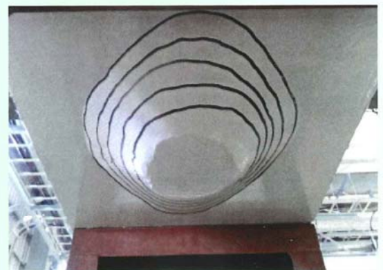
アロンブルコート®Z-X工法の押し抜き試験結果
